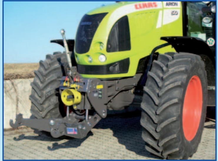
Fronthydraulik u. -zapfwelle bilden eine kompakte Einheit
