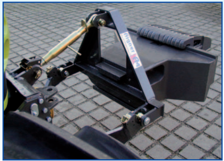
Aufnahmerahmen für Schleppergrundgewicht 3-Punkt-Aufnahme o. für Schnellkuppeldreieck
