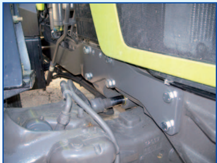
stabiler Rahmen bis zur Kupplungsglocke – keine Begrenzung des Pendelweges der Vorderachse
