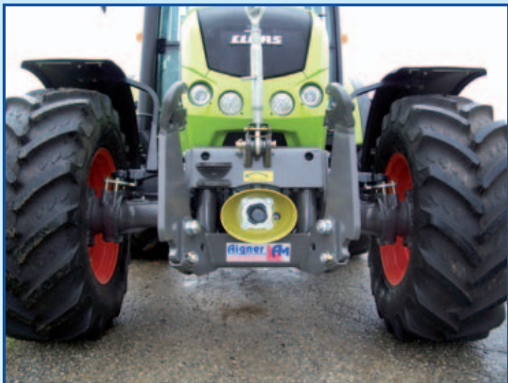
Unterlenker klappen schräg nach innen
