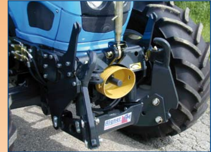
Fronthydraulik u. -zapfwelle bilden eine kompakte Einheit
