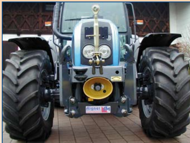
Unterlenker klappen schräg nach innen – optimal bei Kombination FH + Frontlader!
