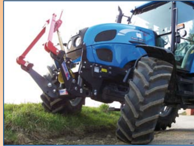
Lenkeinschlag und Pendelweg der Vorderachse bleiben voll erhalten!
