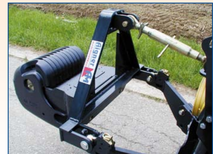
Aufnahmerahmen für Schleppergrundgewicht 3-Punkt-Aufnahme o. für Schnellkuppeldreieck
